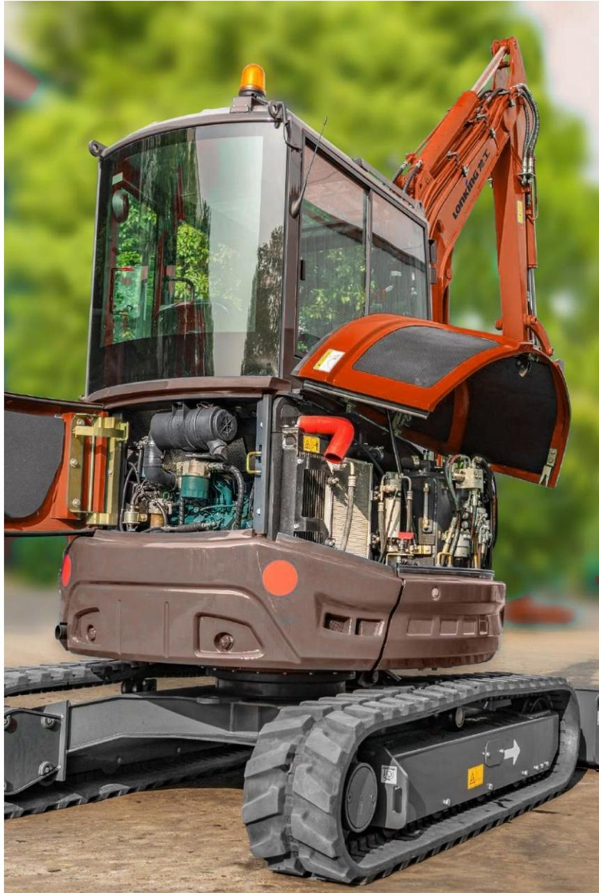
Задний и правый капот могут быть полностью открыты для обеспечения простого и удобного планового осмотра, технического обслуживания и замены фильтров. Конструкция гидрораспределителя очень удобна для обслуживания и ремонта, не требует снятия закрывающих деталей.
