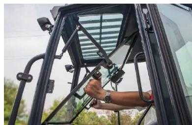
Более широкое пространство для оператора и обзорность обеспечиваются увеличенным передним ветровым стеклом и люком. Кроме того в стандартную комплектацию входят кондиционер, плавающее амортизирующее сиденье, магнитола и стереосистема.
