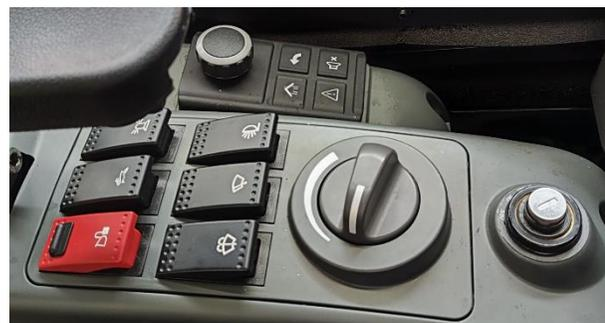
Простое и удобное управление переключателем Электронное управление поворотом дроссельной заслонки и функция автоматического холостого хода.
